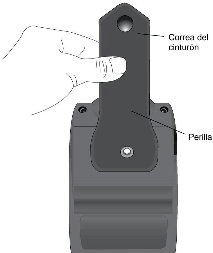
3. Inserte el tornillo en la perilla a través de la correa del cinturón y apriétela en el sentido de las agujas del reloj hasta que esté bien asegurada:
