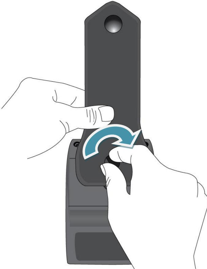
4. Con la correa del cinturón asegurada a la impresora, coloque la parte superior de la misma sobre su propio cinturón:
