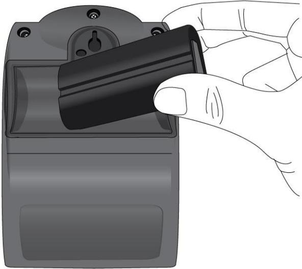
3. Sustituir la cubierta de la batería y girar 90° el seguro de la misma para fijarlo en su lugar:
