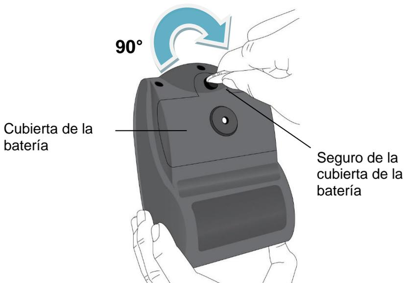
2. Quitar la cubierta de la batería e instalar el cartucho de baterías dentro de la impresora:
