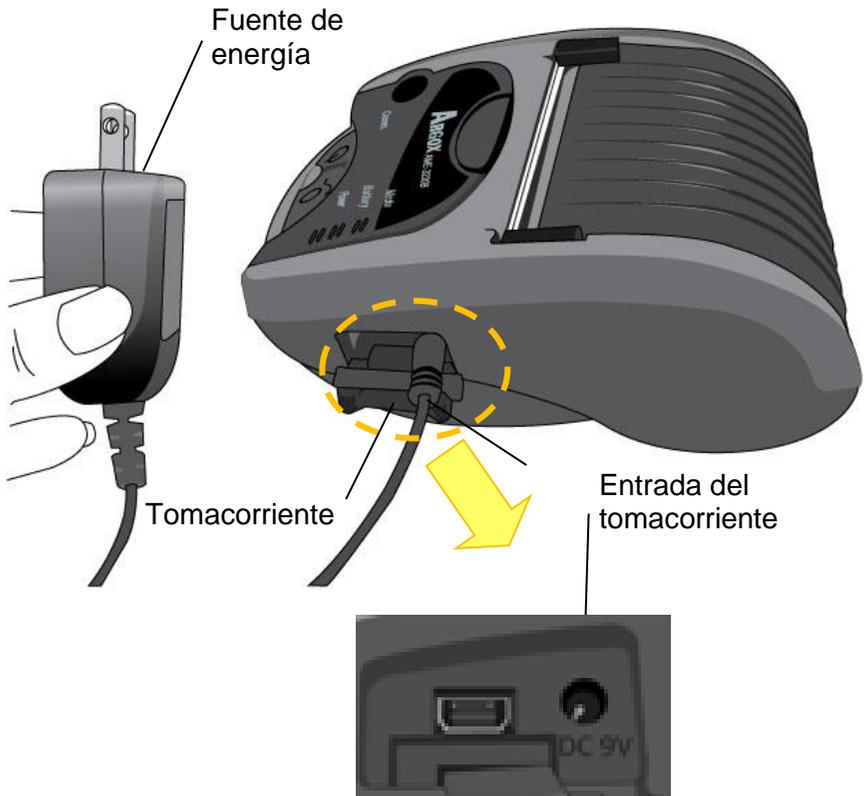
3. La batería está diseñada para el cargado rápido; después de alrededor de **3.5 horas (210 minutos)**, el LED de la batería se apagará, lo que significa que la batería está totalmente cargada y lista para usarse.
