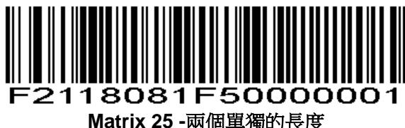
特定範圍內的長度-選擇此項解碼指定範圍的代碼。例如，解碼包含 4 個到 12 個字元的 Matrix 25，首先掃描 **Matrix 25 Length Within Range**，然後掃描 0，4，1，和 2（不足 3 位用 0 補齊）。**數字設置碼**見附錄，改變選擇或者取消一個不正確的輸入設置，掃描附錄中的**取消條碼**。
