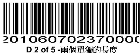
特定範圍內的長度-選擇此項解碼指定範圍的代碼。例如，解碼包含4個到12個字元的D 2 of 5，首先掃描**D 2 of 5 Length Within Range**，然後掃描0, 4, 1, 和2（不足3位用0補齊）。**數字設置碼**見附錄，改變選擇或者取消一個不正確的輸入設置，掃描附錄中的取消條碼。
