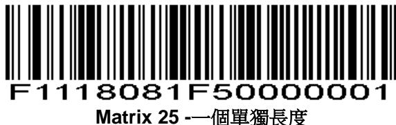
兩個單獨的長度-選擇此長度可用來解碼那些包含兩個既定長度的代碼。例如，選擇Matrix 25 Two Discrete Lengths，然後掃描0, 2, 1, 4，只可用來解碼包含2個或者14個字元的Matrix 25碼制。數字設置碼見附錄，改變選擇或者取消一個不正確的輸入設置，掃描附錄中的取消條碼。
