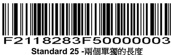
特定範圍內的長度-選擇此項解碼指定範圍的代碼。例如，解碼包含 4 個到 12 個字元的 Standard 25，首先掃描 Standard 25 Length Within Range，然後掃描 0, 4, 1, 和 2（不足 3 位用 0 補齊）。數字設置碼見附錄，改變選擇或者取消一個不正確的輸入設置，掃描附錄中的取消條碼。
