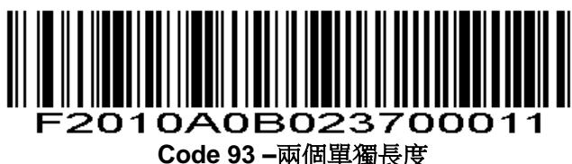
特定範圍內的長度-選擇此項解碼指定範圍的代碼。例如，解碼包含4個到12個字元的Code 93，首先掃描**Code 93 Length Within Range**，然後掃描0, 4, 1, 和2（不足3位用0補齊）。數字設置碼見附錄，改變選擇或者取消一個不正確的輸入設置，掃描附錄中的取消條碼。
