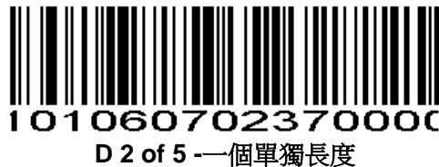
兩個單獨的長度-選擇此長度可用來解碼那些包含兩個既定長度的代碼。例如，選擇**D 2 of 5 Two Discrete Lengths**，然後掃描0, 2, 1, 4，只可用來解碼包含2個或者14個字元的D 2 of 5碼制。**數字設置碼**見附錄，改變選擇或者取消一個不正確的輸入設置，掃描附錄中的取消條碼。
