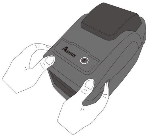
2. Puxe os suportes do rolo de mídia para deslizar para fora e coloque o rolo de etiquetas entre os suportes. Certifique-se de que o lado da impressão está para cima e o rolo de mídia está apertado firmemente pelos suportes.
