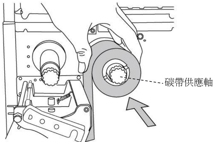
4. 將碳帶繞過印字頭模組下方。將碳帶前緣貼到碳帶捲筒，並將部分碳帶捲到捲筒上。確定將碳帶的碳粉層朝下。
