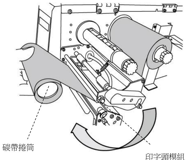
5. 將碳帶捲筒插入碳帶回收軸，轉動回收軸，拉緊碳帶。
