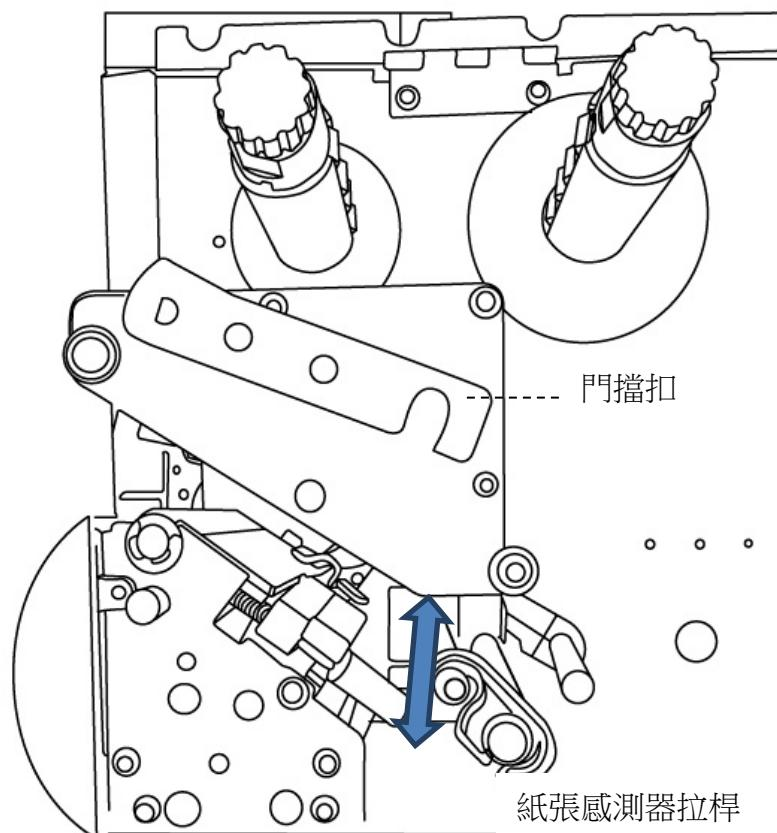
務必確認紙張感測器位置標示(Media sensor position mark)座落在標籤紙孔洞的正上方。
